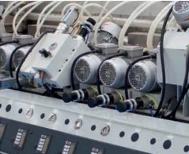
Las válvulas proporcionales para la gestión automática de la presión de las herramientas de pulido en función del espesor reducen notablemente los tiempos de ajuste de la máquina.
