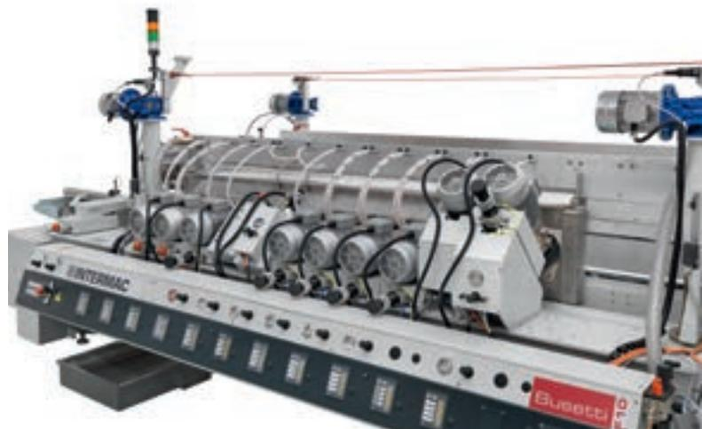
Los largueros están diseñados para mantener el agua alejada de los patines de desplazamiento de los mandriles y su robustez garantiza la máxima fiabilidad y la ausencia de vibraciones durante la amoladura.
