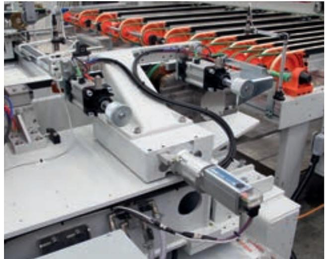
La regulación automática de la línea aliada de extracción, según el espesor, evita intervenciones manuales del operador.
