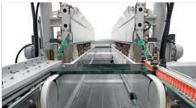
Los grupos de alineación del vidrio en la entrada ayudan al operador a colocar correctamente la pieza en la máquina gracias a una adecuada longitud de la zona de entrada.
